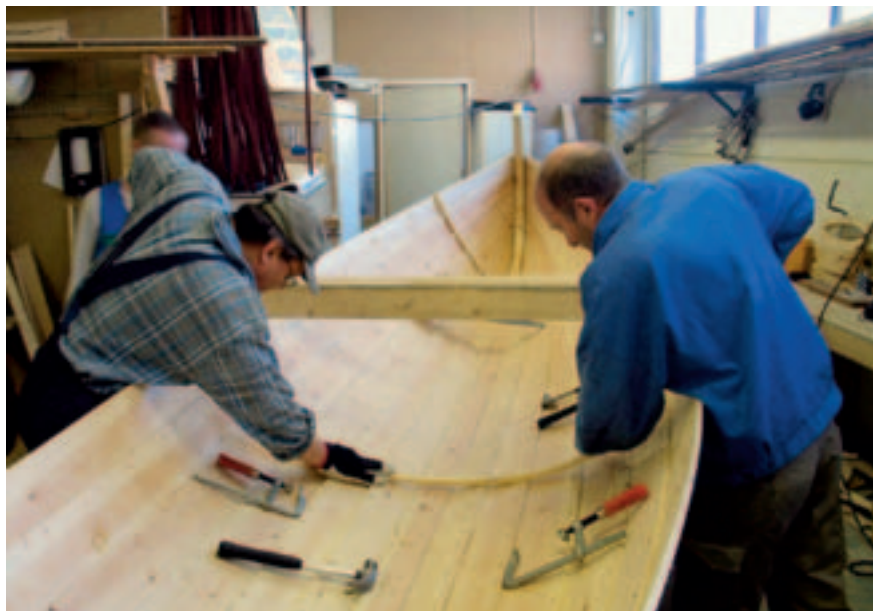
Puuveneveistoa opetetaan aikuisopiskelijoille. Menossa näyttävä työvaihe, kaarien kiinnitys.
